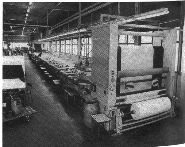
Flachfilmdruckmaschine – druckt bis zu 20 Farben in einem Arbeitsgang
