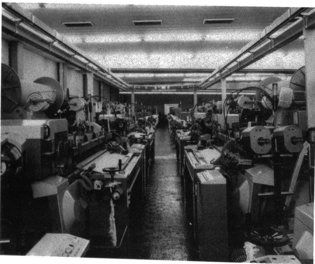
Webmaschinenanlage der Feinweberei Elmer AG in Wald in der Schweiz: Neben 136 konventionellen Rütli C-Maschinen setzt das Unternehmen 24 Sulzer Rütli Luftdüsenwebmaschinen L 5001 und L 5100 sowie 25 Sulzer Rütli Vierfarben-Greiferwebmaschinen des Typs F 2001 in Arbeitsbreiten von 190 bis 230 cm ein.
