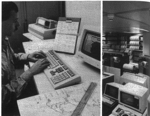
Dank dem speziellen CAE-Programm erscheinen die genauen Dimensionen der Rohrführung und Düsen einer Halon-Trocken-Löschanlage innert kürzester Frist als wirtschaftlichste Lösung auf dem Monitor (Foto Cerberus)
