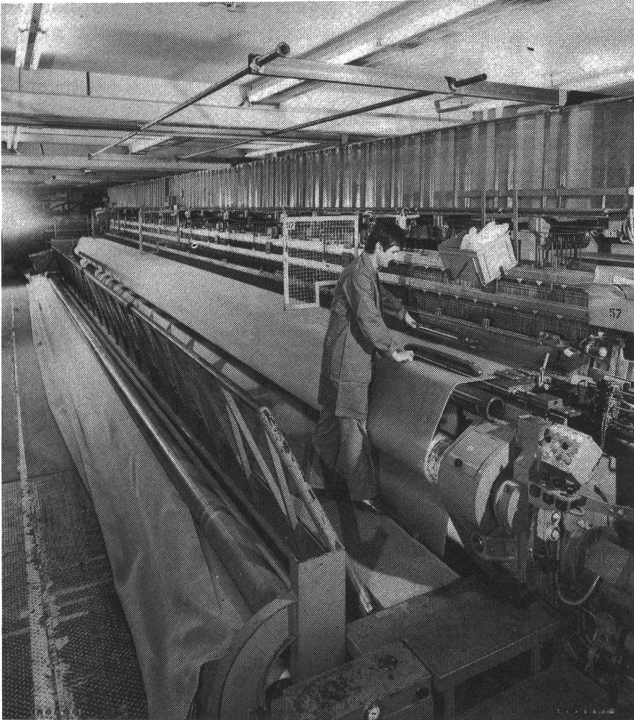
Webmaschine in Filztuchfabrik. 18 Meter breit. Herstellung von Maschinenbespannungen für die Papierindustrie.
