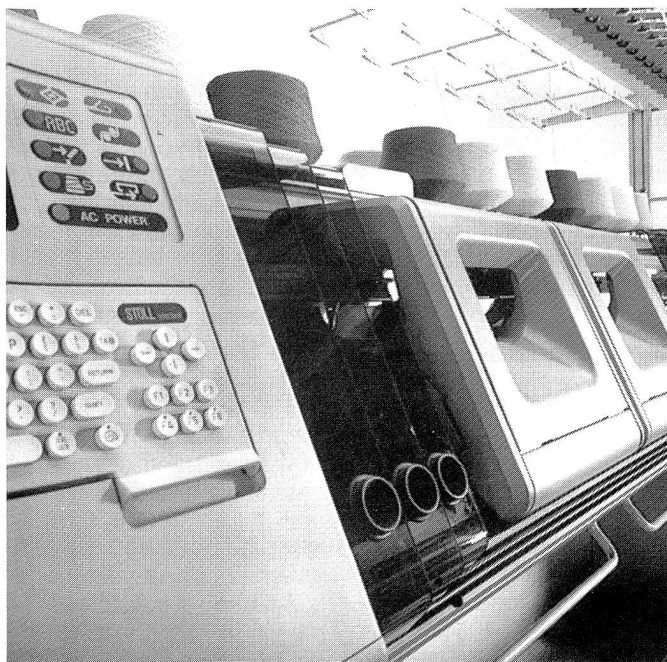
Wird die Tandemmaschine CMS 402 als 4er-System gekoppelt, ist sie ebenfalls eine perfekte Intarsienmaschine
