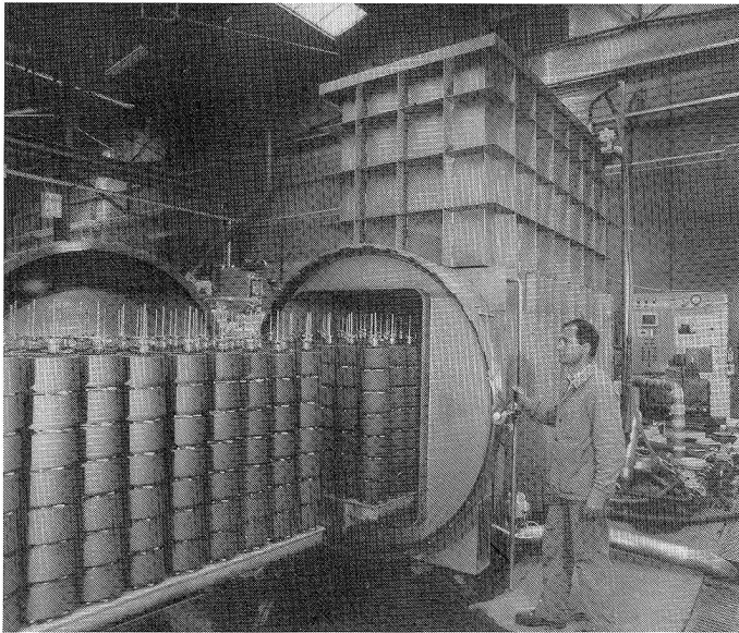
Die mikroprozessorgesteuerte Horizontalfärbemaschine Ecobox der französischen Firma Barriquand in Roanne zeichnet sich durch ihren platzsparenden Aufbau und durch die gleichbleibend hohe Qualität des reproduzierbaren Färberegebnisses aus.
