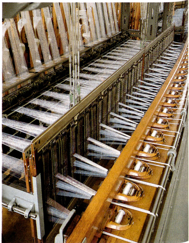
Für Schmalgewebe mit beidseitig gleichen Kanten sind Schifflimaschinen unerlässlich.
