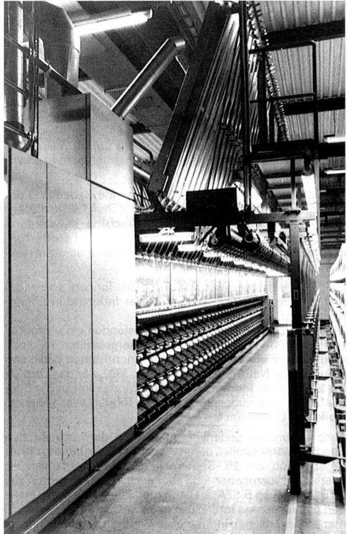
Werksfoto Barmag: Barmag-Strecktexturiermaschine FK6S-12 zur Herstellung feiner Polyamid-Strumpfgarne. Diese Maschine ist weltweit bei fuhrenden Texturierbetrieben im Einsatz. Sie gilt als leistungsfahig und betriebssicher. Ihre technische Ausstattung ist neuester Stand der Technik.
