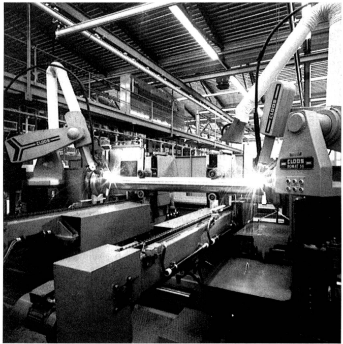
Sulzer-Rüti-Teilfamilie Walzen: Schweissanlage mit zwei Robotern zum Anschweissen der Walzenboden
