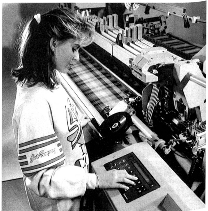
Sulzer-Rüti-Achtfarben-Greiferwebmaschine G 6100, ausgerüstet mit zentraler Mikroprozessorsteuerung
