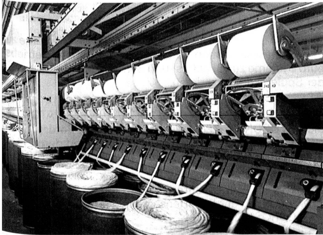
Rotor-Spinnpul-Automat AUTOCORO® 240, ausgestattet mit der neuen Spinnbox SE 9, die Rotordrehzahlen bis 130 000 Rotorumdrehungen erlaubt.
