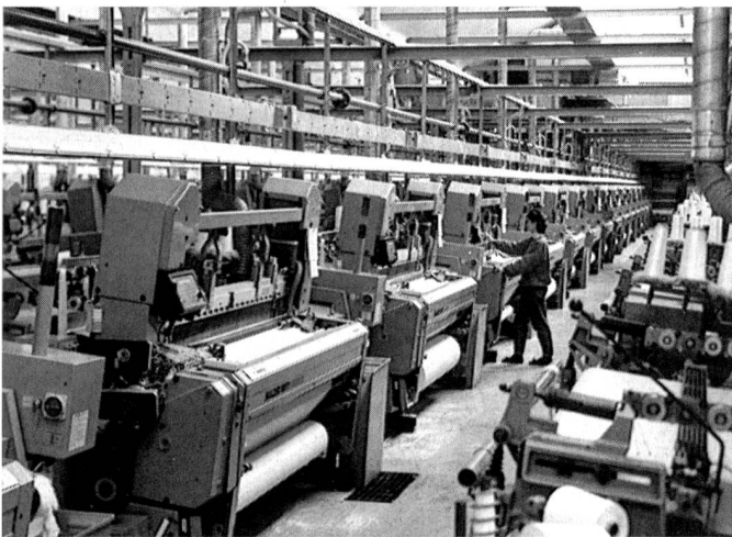
Seidenweberei Reutlingen, Bundesrepublik Deutschland: Webmaschinenanlage mit 190 Sulzer-Rüti-Luftdüsenwebmaschinen L 5100
