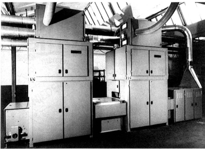
Flockenmischanlage mit Wiegespeisern PWSE, mit elektronischer Waage
