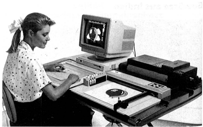
Moderne Strickereiindustrie: Ein Computerset mit Lesegerät, Farbplotter und Stanzmaschine übernimmt die Steuerung der Stickmaschinen. Alte Karten können «retour» in die Computerkartei abgelegt werden. Bild: ATI Stitchbuilders, England
