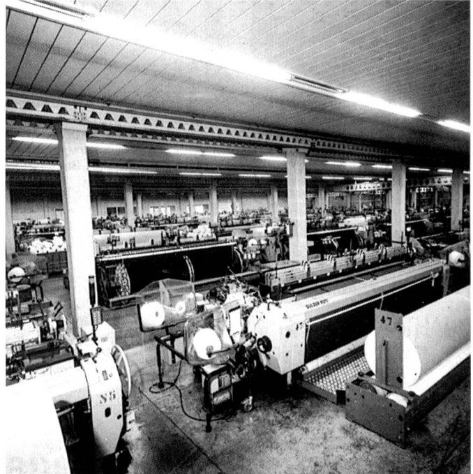
Webmaschinenanlage der Tessitura di Robecchetto Candiani S.p.A. in Robecchetto, Italien. Auf 108 Sulzer Rütli Projektilewebmaschinen mit Schussmischer stellt das Unternehmen qualitativ hochwertige Denimgewebe her.
