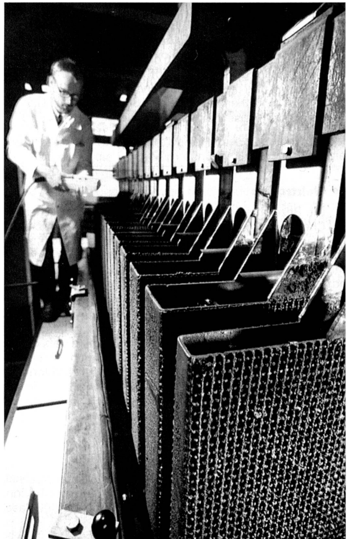
PD Dr. Wolfgang Samhaber der Sandoz AG experimentiert in seiner Pilotanlage zur Kupferabscheidung. An den dreidimensionalen Kathoden scheidet sich das Kupfer ab.
