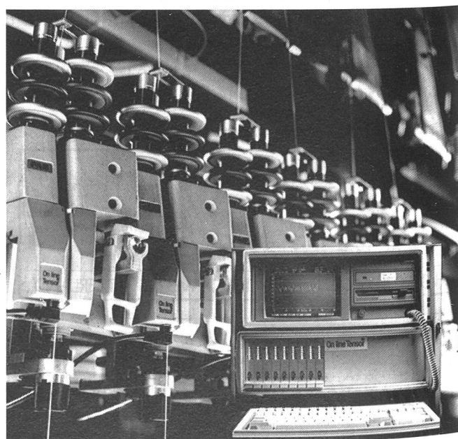
Das Fadenzugkraft-Messsystem «On-line Tensor» besteht aus Sensor, Auswertelektronik, Rechnersystem, Software. Bild: FAG Kugelfischer
