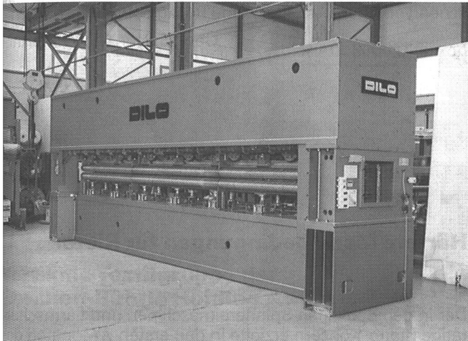
Dilo-Nadelmaschine Typ DI-LOOM OD-I/70
