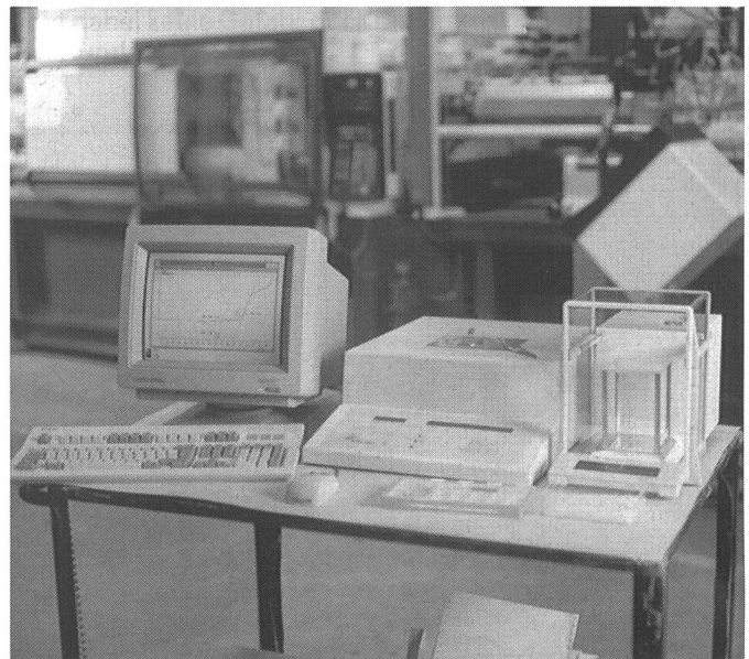
Das neue Mettler DSC12E ist ein kompaktes, leicht bedienbares Thermoanalysen-Instrument mit eingebauter Messzelle.
