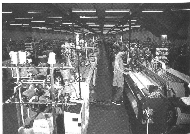
Der Websaal ist ausschliesslich mit Vamatex-Einheiten bestückt, inzwischen sind noch Wanderbläser installiert worden.
