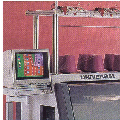
Abb. 10: Der Farbmonitor der Steuereinrichtung des Typs MC-745
