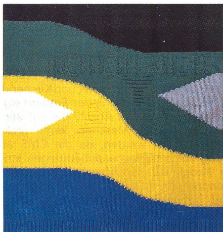
Abb. 15: Farbstrukturmuster von der MC-720, (mit Sondereinrichtung Uni-press gearbeitet)
