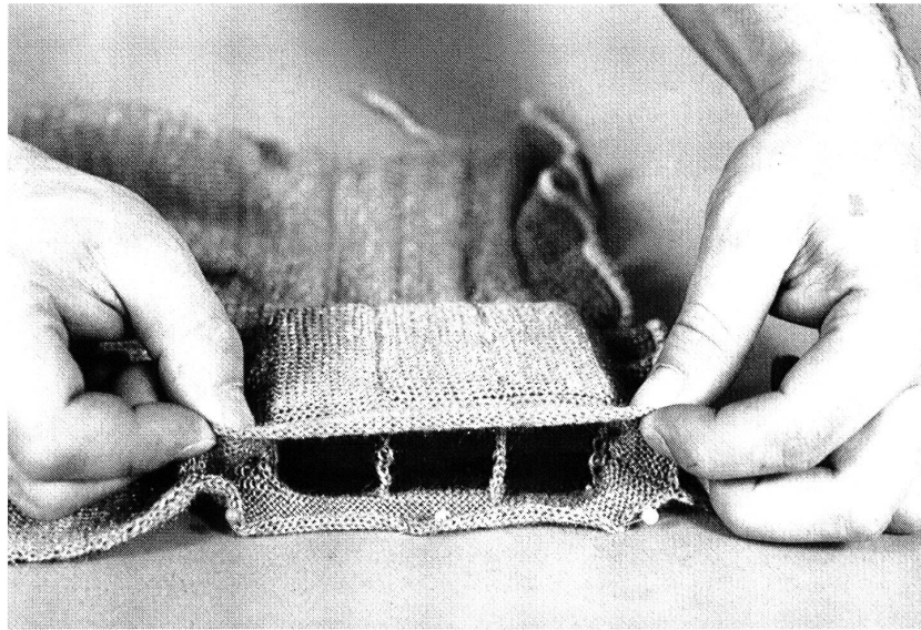
Gestricktes Bauelement, bei dem zwei Gestrickbahnen mit Stegen in Längsrichtung verbunden sind.
