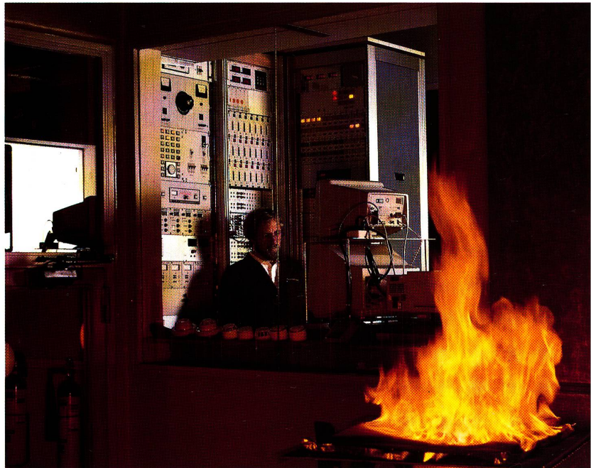
Forschung und Entwicklung. Aufzeichnung, Speicherung und Auswertung von Brandphänomenen, hier insbesondere Infrarot-Strahlung und Temperatur-Abstrahlung der Flamme eines Polyurethanbrandes. (Photo Cerberus)
