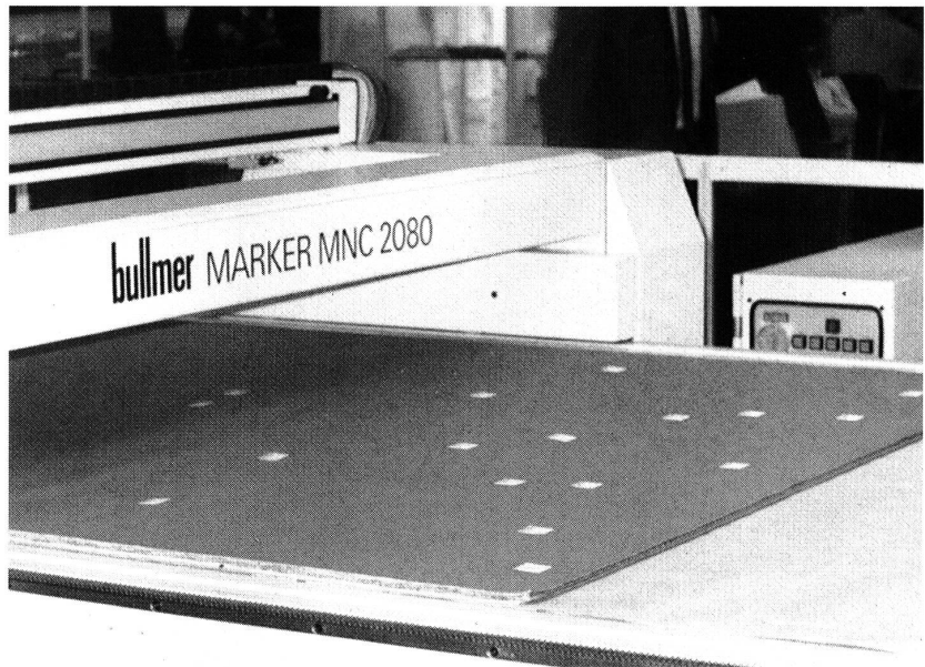
Labeler-Maschinen zur Anbringung von Etiketten auf dem zu schneidenden Material (Hier von Bullmer)
