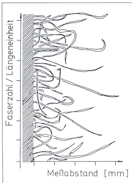
Abb. 1: Darstellung des Messprinzips des Zweigle-Haarigkeitsgerätes.
