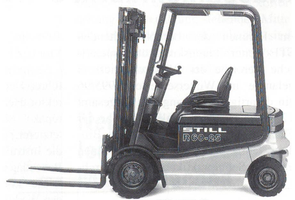
Elektro-Vierradstapler, Baureihe R 60 Foto: STILL
