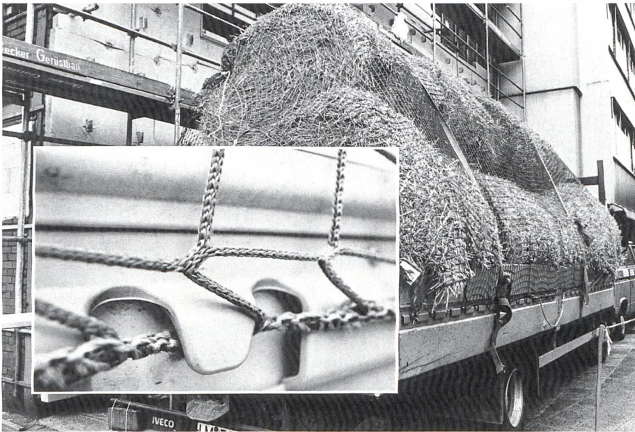
Schutz-, Sicherungs- und Transportnetze, hergestellt auf ein- und doppelbarrigen Raschelmaschinen der Typen RS 4 N-2M-F bis RSF 8 N-6M und HDR 8 EH.
