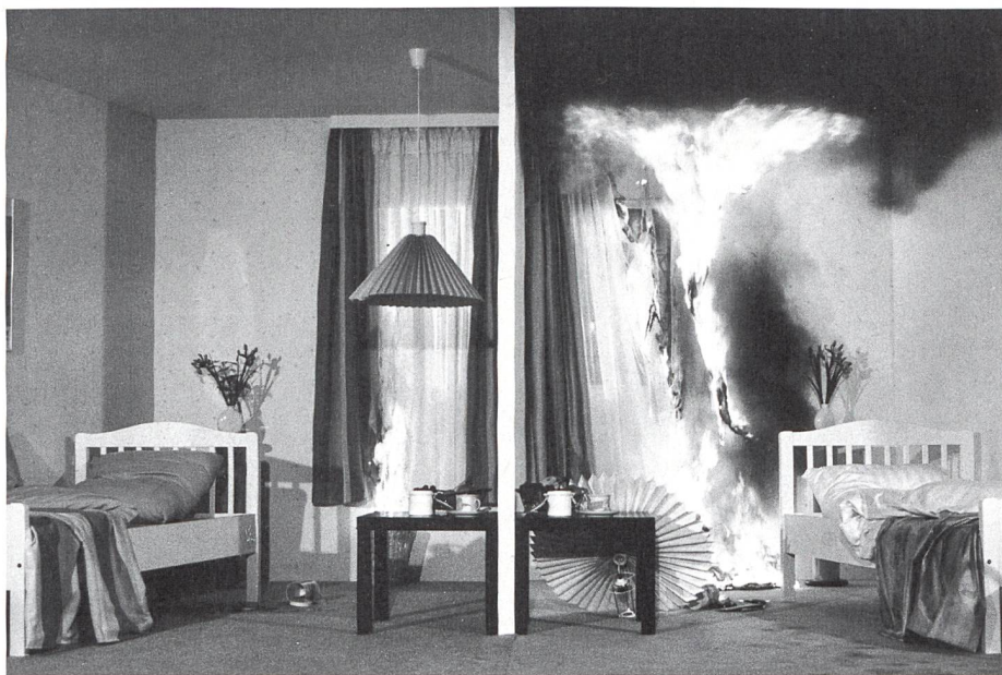
Vergleich von zwei Zimmern. Zimmer rechts, Einrichtung mit Heimtextilien ohne flammhemmende Ausr stung. Zimmer links mit Heimtextilien aus Trevira CS. Nach gleicher Branddauer ist die unterschiedliche Brandausbreitung bereits gut zu erkennen.
