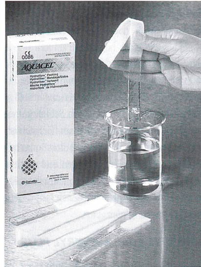
Bild 1: Queen's Award for Technological Achievement. Testen der Saugfähigkeit von Hydrocel
