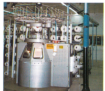
Ein Wanderreiniger von SOHLER AIRTEX an einer Rundstrickmaschine von Terrot Foto: SOHLER AIRTEX
