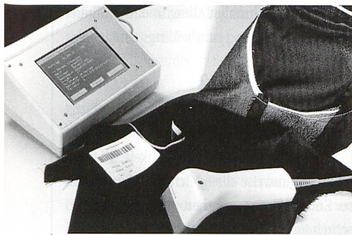
Abb. 3: Das Produktionsleitsystem mit Bare-Code-Leser zur Bereitstellung der Produktionsdaten am Arbeitsplatz
