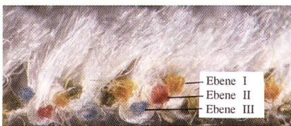
Bild 22: 3/6-Bindung mit grossrapportiger Schussfolge
