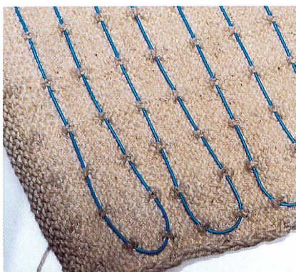
Abb. 1: Einlegetechnik am Beispiel eines eingelegten Kabels
