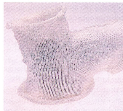
Abb. 5: Komplett gestrickte Rohrträgerverbindungen
