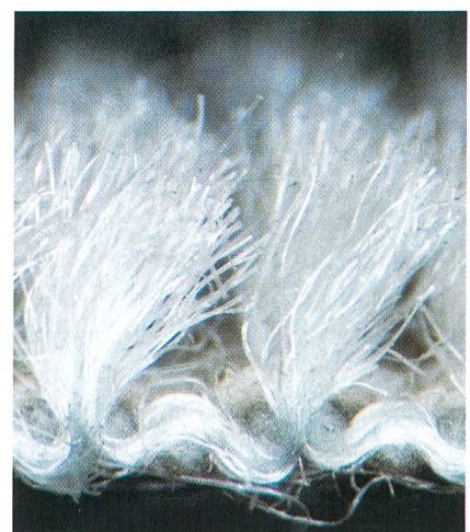
Bild 5: Glatter Velours, mit W-Noppe, zweipolig
