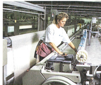
Abb. 2: Die meisten Maschinen bei Synthetic Industries sind Projektilewebmaschinen von Sulzer Textil, in erster Linie vom Typ P7100, die in verschiedenen Werken Millionen von Metern technischer Gewebe produzieren – genutzt z. B. zur Abtrennung weicher Erdschichten beim Strassenbau.
