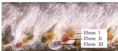
Bild 22: 3/6-Bindung mit grossrapportiger Schussfolge
