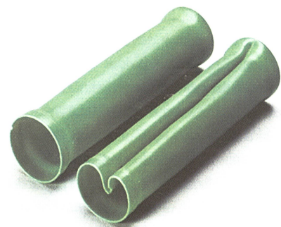
Abb. 3: Eingeknickte Hülsen beim Filamentdämpfen, links mit Contexxor®-System konditioniert
