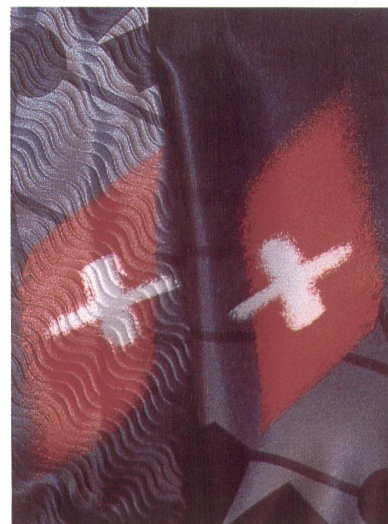
Rechts das rein auf Schnelligkeit ausgerichtete frühere Material – links das aufgrund der Kaman-Theorie entwickelte Eschler-Speziallaminat mit S-förmiger Prägung (Spiraleffekt «Votex») für mehr Sicherheit im alpinen Rennsport.
