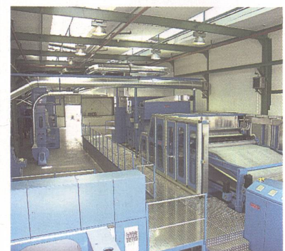
Viele Bearbeitungsstufen sind bis zu einem fertigen Vlies nötig. Hier in der Mitte des Bildes die sogenannte Krempel, die Vorstufe zum Vliesleger
