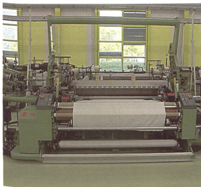
Greiferwebmaschinen können Artikel weben, die zwei Kettbäume erfordern
