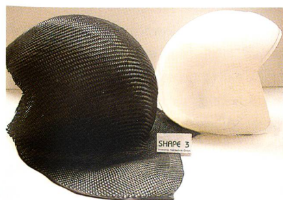
3D-gewebte Helmschale «Open Face»
