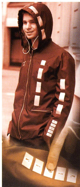
Infineon-Anorak mit Textildraht (Datenübertragung)
