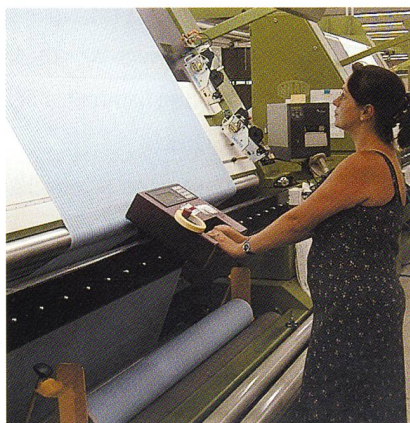
Sichtprüfungen auf dem Kontrolltisch: Hier wird die laufende Warenbahn auf Fehler untersucht und entsprechend markiert.
