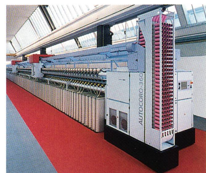
Abb. 1: Der Autocoro 360 – die produktivste automatische Rotorspinnmaschine auf dem Markt
