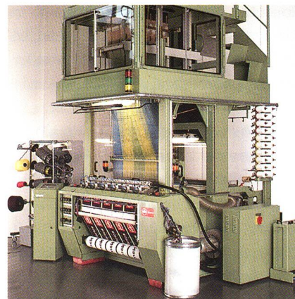
Moderne Luftdüsen-Webmaschine in SILENT-Ausführung für die Schalproduktion
