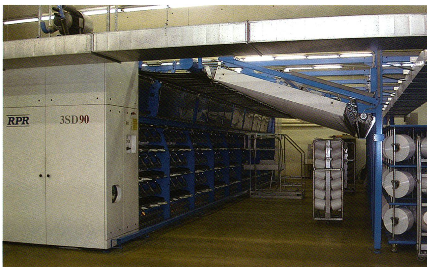
Modernster Maschinenpark – unser Bild eine Texturiermaschine von RPR (1)
