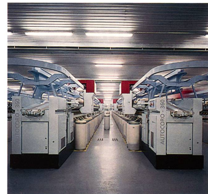
Abb. 3: FANCYNATION – zur Herstellung von Effektgarnen
