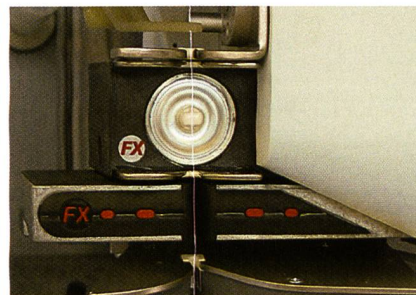
Abb. 2: Ecopack FX Längenmessung
