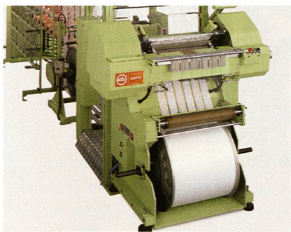
MDR42 – durch die Möglichkeit, maximal 24 Schussstangen bei unbegrenzter Rapportlänge einzusetzen, eröffnen sich ganz neue Mustermöglichkeiten
