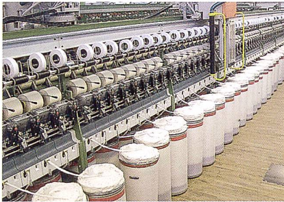
Abb. 5: Die Rotorspinnmaschine BT 904 für elastische Rotona®-Garne
