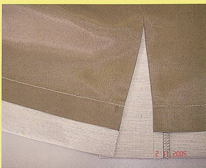
Übertritt Saum-Ecke Variante I mit sichtbarer Overlocknaht
