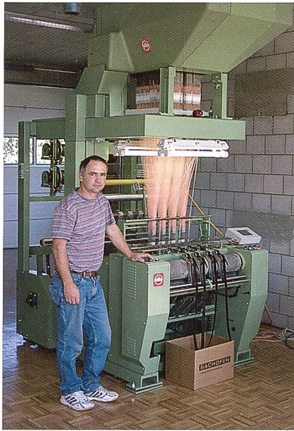
Abb. 3: Die neue Etikettenwebmaschine, Typ MVC, geliefert von der Jakob Müller AG in Frick
