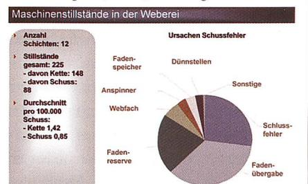
Abb. 5: Fehleranalyse Schussfadenbrüche
