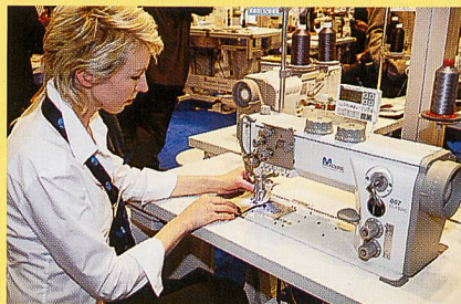
Industrienähmaschinen Reihe M-Type: Doppelstich-Flachbrettmaschine – DÜRKOPP-ADLER, Foto: Kölnmesse
